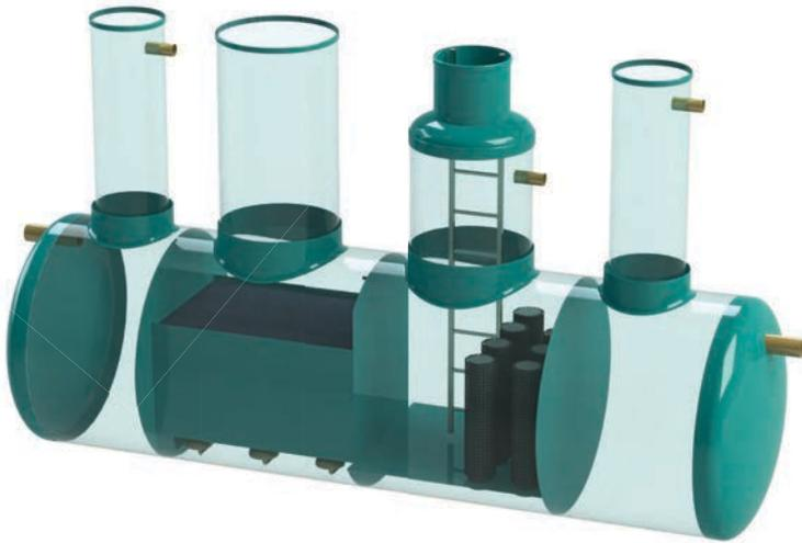
Для очистки воды на автомойке с объемом сточных вод 25-40 м<sup>3</sup>/сут. рекомендуем использовать очистное сооружение для автомоек Rainpark ПО+БП+БМО+ЕН. Внутри емкости установлены стеклопластиковые перегородки, которые делят емкость на 4 отсека: пескоотделитель, отсек аэрации, маслобензоотделитель и накопительную секцию.
