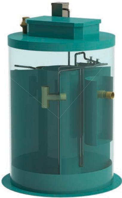
Rainpark-BioPURIT — это полностью автоматизированная система биологической очистки бытовых сточных вод. В основе технологии лежит принцип прикреплённой микрофлоры с аэрацией, обеспечивающий высокую степень очистки. Данная технология идеально подходит для очистки бытовых стоков небольшого объёма и приспособлена к условиям неравномерного потока и изменения состава поступающих сточных вод.
