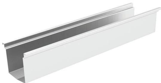
Лотки с уклоном удобны в монтаже и эксплуатации, т.к. позволяют производить обустройство пола с наклоном только к лотку, что особенно важно при небольшой толщине перекрытий и ограниченной высоте помещений.
