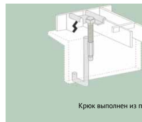
Стандартный зажим Болт М8х70 по DIN 558 Гайка М8 по DIN 557
