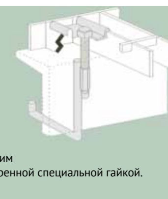
Стандартный скрепитель Крепление настила с помощью саморезов
